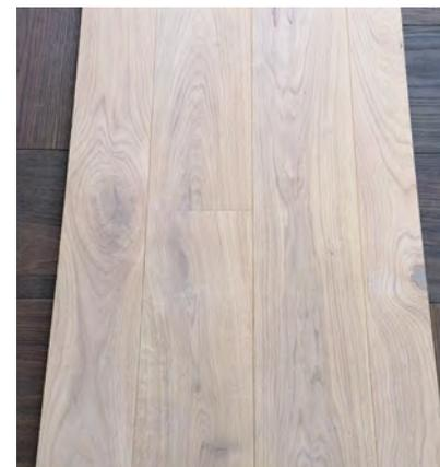
Assemblage par rainures et languettes ; multicouche composé de 2 couches, le bois massif et le contreplaqué ; couche d'usure en chêne 4mm ; épaisseur du parquet 16mm ; largeur du parquet 18cm. La partie des planches sont sans défauts toutefois un diamètre de 10mm max est toléré. La pose est collée sur la chape flottante.
